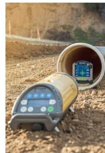
Kanalbaulaser senden einen automatisch horizontalen oder definiert geneigten Laserstrahl als Bezugsachse aus. Statt eines Handempfängers wird der Laserstrahl bei diesen Geräten auf eine spezielle Zieltafel geleitet.
