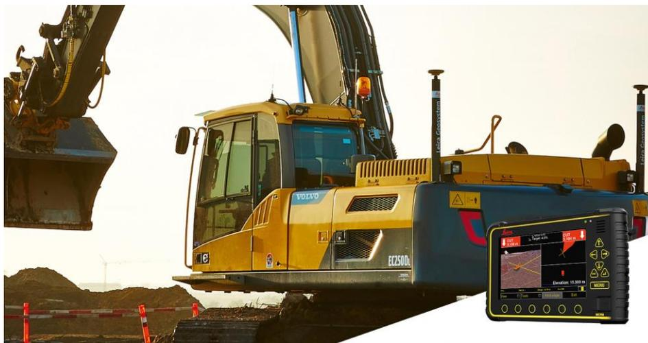
Abbildung: Bagger mit 2 GNSS-Antennen und Steuerbox
